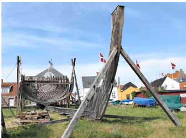
Påbörjat bygge av en spantsträckt skonert.
