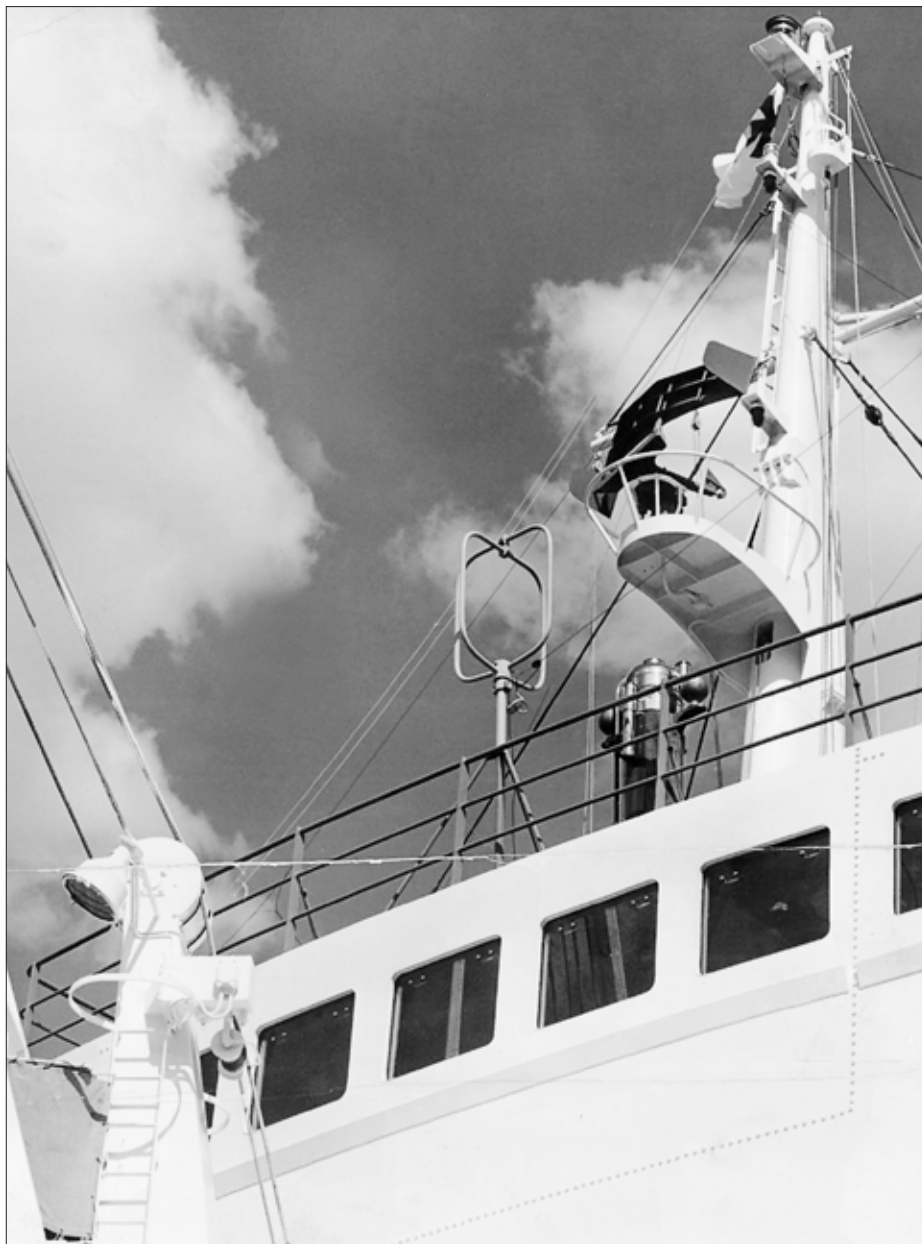
Ett nybyggt fartyg, från Eriksbergs Varv till Sahlénrederierna i Stockholm. På bryggans tak syns nakterhuset med kompassen, ramantennen och radarn. Foto från Ramantenn AB.
