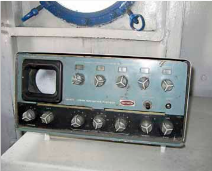
Mottagare för det världsomspännande långvägssystemet LÖRAN. Foto från Göran Sändare.
