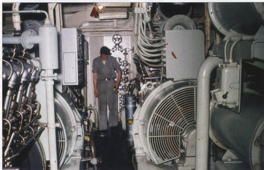
M/s Buenos Aires hjälpmotor PA-10-2 var en av de tre PA-10-hjälpmotorerna ombord.
