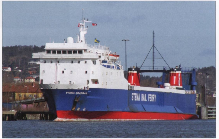
Stena Lines roro-färja Stena Scanrail , som också kan ta ombord järnvägs-vagnar, vid Kvillepiren i sitt färjeläge i april 2006.
