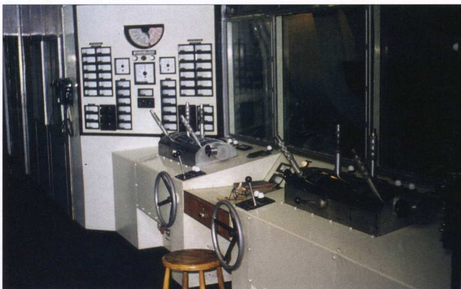
En bild från kontrollrummet i m/s Buenos Aires . På bilden syns instrumentpanelen och manöverplatsen för ena sidans (SB?) motorer, och en skymt av manöverplatsen för den andra sidans motorer.
