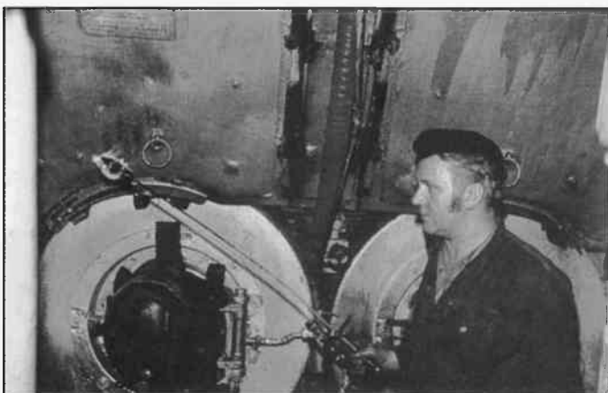
Pannrummet är ombord på s/s Monarda där eldaren just skall sticka fyr i en oljebrännare. Fotona från pannrummen på detta uppslag är av senare datum än då Mirafjord seglade. De återger dock miljön där. Foto av Bertil Söderberg i mars 1971.
