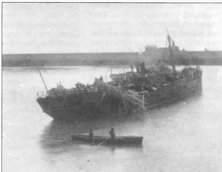
3. S/s Olaus Olsson med förlorad däckslast, aktermast och skorsten.
