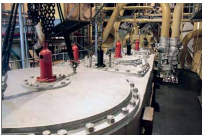
Maskintoppen på den 2500 IHK ångmaskinen.
