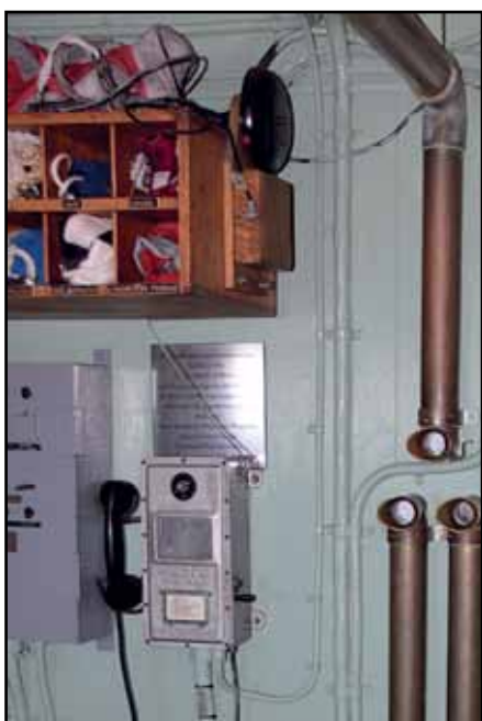
På skottet bakom ratten finns talrör till maskinrummet.
