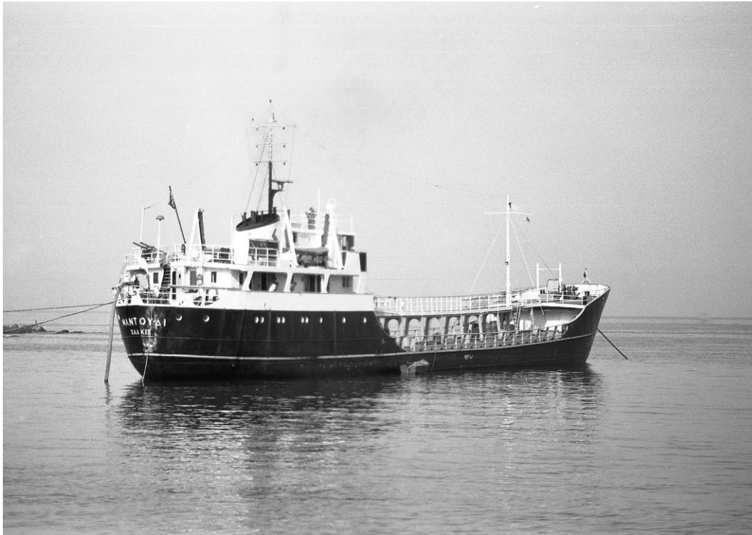
Bild 3. Här ligger Mandoudhi vid Kyrmassi på ön Evia. Observera slangen i aktern som är förbunden i land för lossning av olja. Ingen brygga eller hamn.
