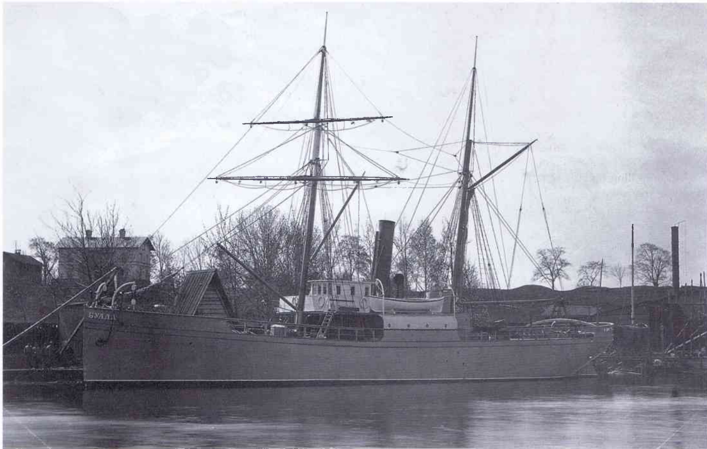
Buddha hade till skillnad från Zoroaster integrerade tankar, inte lösa i lastrummet. Buddha och systerfartyget Nordenskiöld transporterades i sektioner till Kaspiska Havet, där de kom att ingå i bröderna Nobels flotta av tankfartyg. Arkivbild Sjöfartsmuseet Göteborg.
