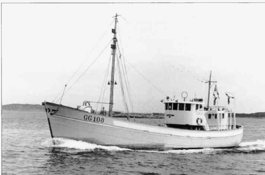
Skrovet till GG 108 Najaden från Öckerö, byggde varvet i Saltvik som underleverantör till J.W. Bergs Varv & Mek. Verkstad på Hälsö. Foto: Helge Kärrbrant.
