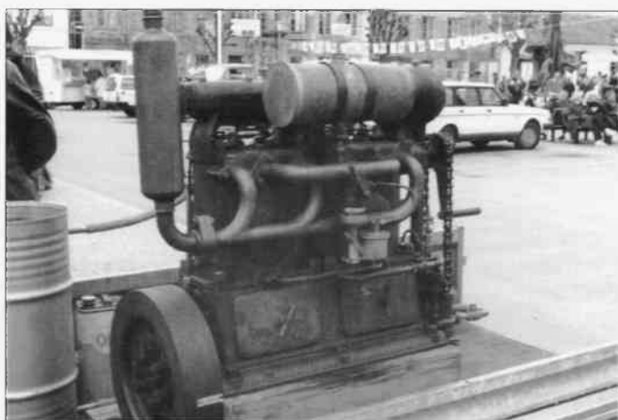
En okänd petterssonbåt och dess maskin, en Penta C4 bensinmotor. Foto från Tomas Davidsson.
