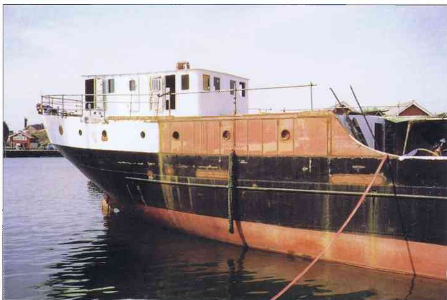
Poopen förlängs med delar från Gryts varv. Foto: Lennart Martinson
