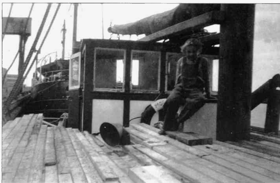
Röret som sticker upp mellan bräderna var ventilation från lastrummet, för att förhindra explosion med laster av kalkkväve.
