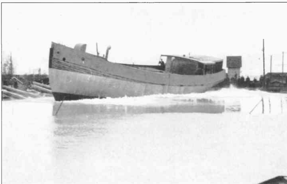
I Sjötorp användes en ovanlig metod för sjösättning av nybyggna, nämligen sidle- des. Här går galeasen Peter i sjön år 1949. Foto från Ingvar Thörn.
