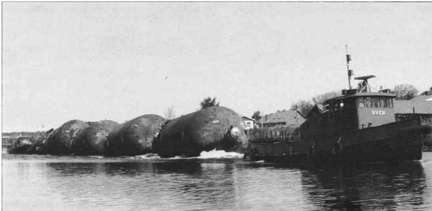
Ett ovanligt bogsersläp med reaktortankar som sjösatts och sammankopplats för transporten. Foto: T. Johannesson 7 juni 1969.
