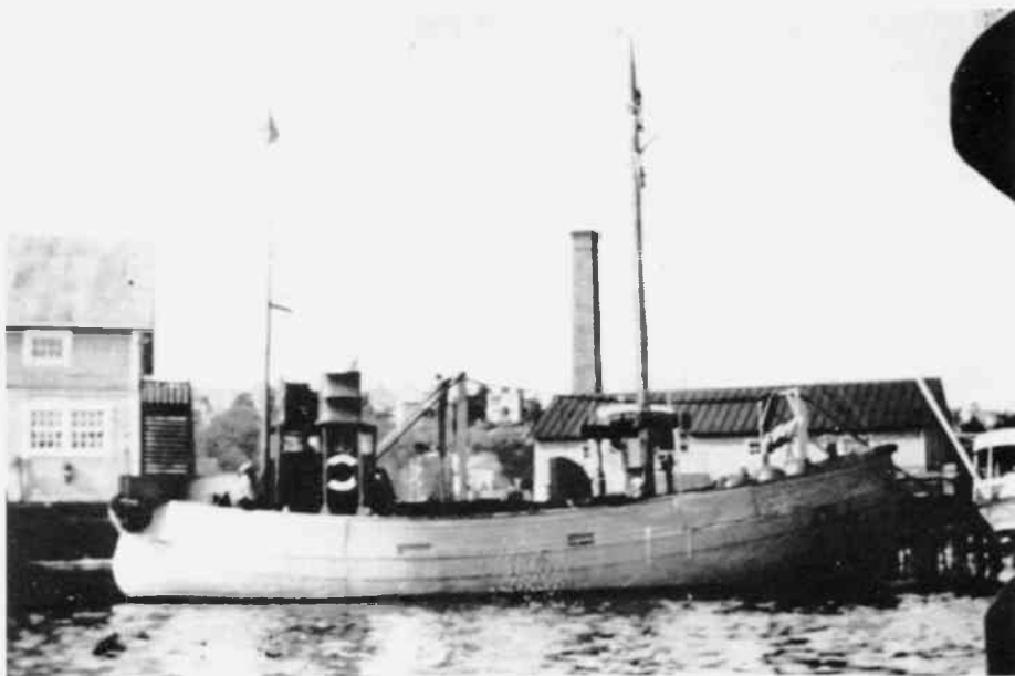
Ganler som vedettbåt under kriget. Akterskeppet är ombyggt för minsvepning. Foto från Eskil Magnusson.
