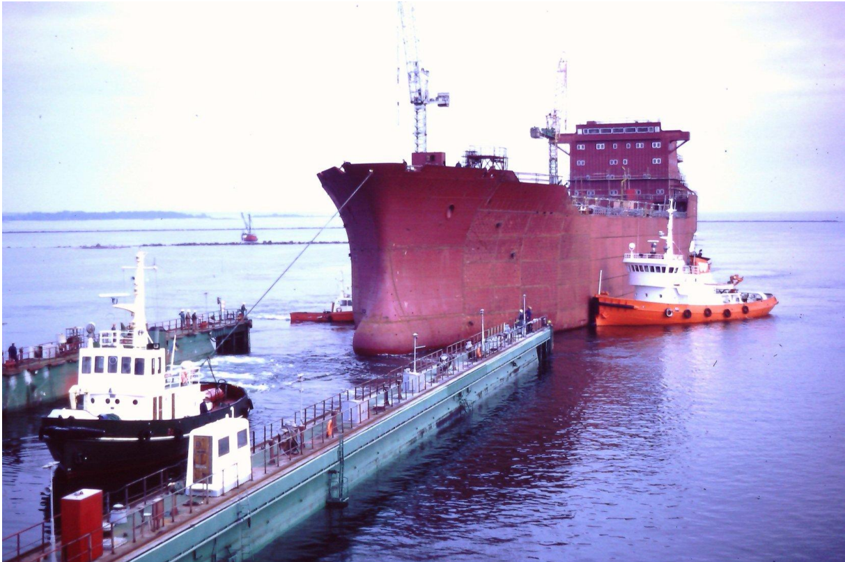
Dockning av nybyggda Ariadne i Oskarhamns flytdocka 1982. Foto: Per-Åke Kvick
